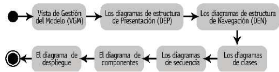
Fig. 7. Método para la modelación de una aplicación multimedia educativa aplicando los diagramas más importantes de ApEM-L 1.5.
